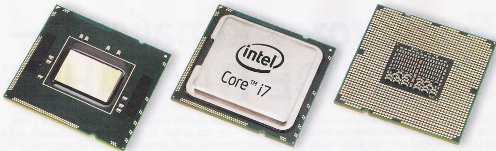
Процессор Bloomfield в корпусе LGA-1366 стал первым четырехъядерным ЦП компании Intel, выполненным на одном кристалле. Площадь кристалла — 263 мм 2 , размеры процессора — 42,5×45 мм
